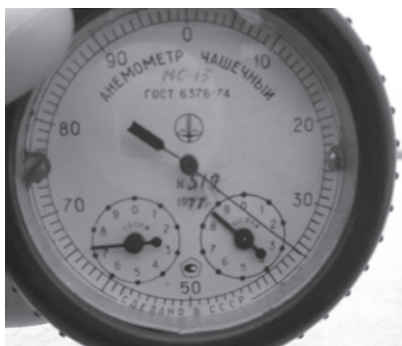
Рис. 3. Анемометр чашечный МС-13 № 519 и его градуировочный график
