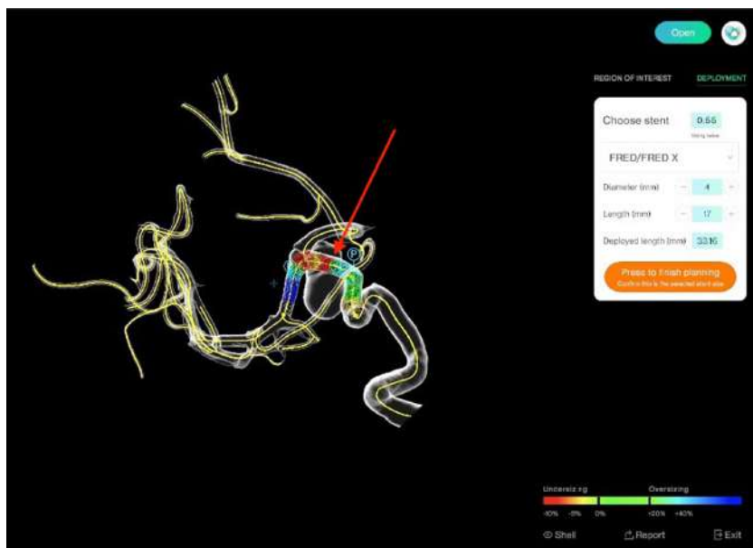
Рис. 11. Приклад використання програмного забезпечення PreSize Neurovascular. Віртуальна проєкція імплантації FRED X розміром 4 ×23/17 мм (червона стрілка)
