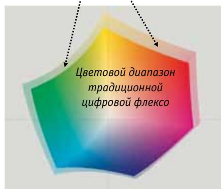
Рис. 3. Сравнение цветового диапазона изображения при традиционном растривании и по технологии DigiCap NX
