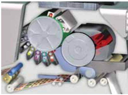
Рис. 1. Все слои краски наносятся на материал за один прогон на одном печатном узле
