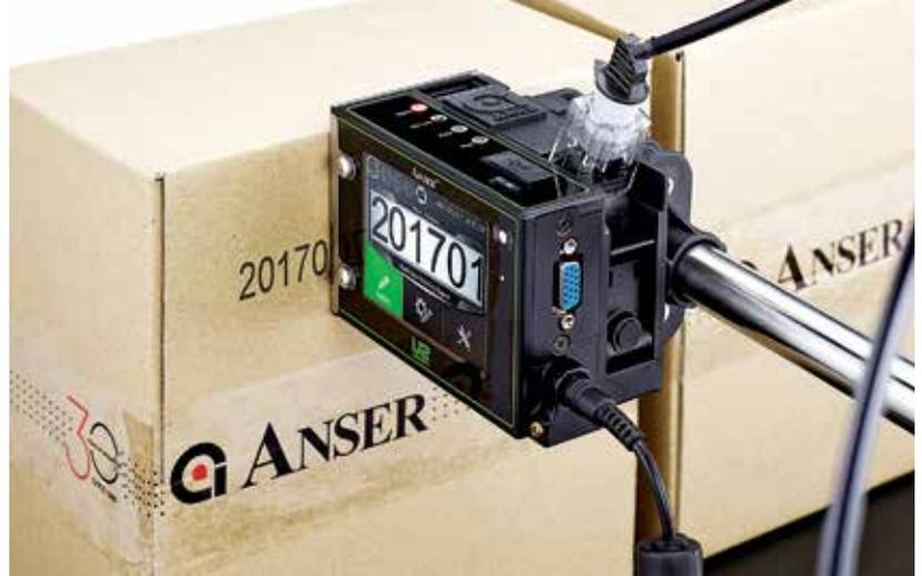
того воздуха. Также проста и эксплуатация маркиратора. Нет затрат на дорогостоящие печатающие головки, их промывку и консервацию, нет расходов на растворители. Надо просто вставить в маркиратор следующий картридж и продолжить работу. Таким образом, эксплуатационные затраты при использовании **Anser** ниже в несколько раз, чем для традиционных принтеров.
