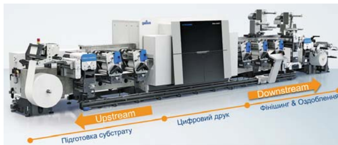
Рис. 7. Друкарська машина Gallus Labelfire 340
