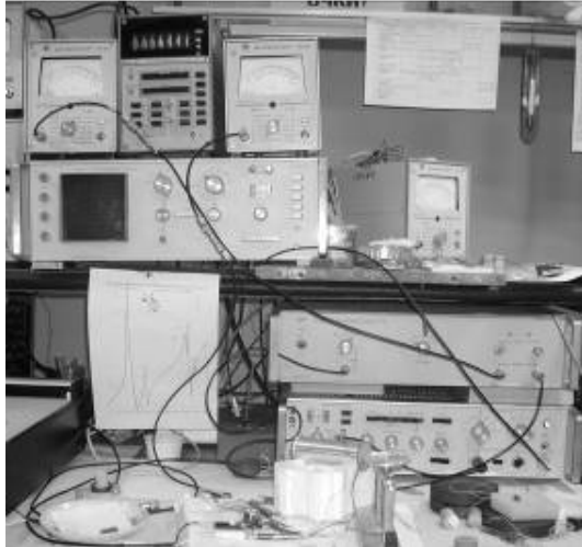
Рис.2. Експериментальна установка з генератором Х1-46
