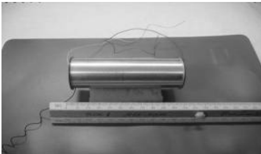
Рис.1. Досліджуваний експериментальний зразок із алюмінієвого сплаву Д16Т
