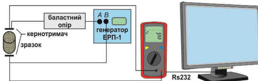
Рис. 3. Схема вимірювань зміни різниці потенціалів на зразках гірських порід, насичених моделлю пластової води
