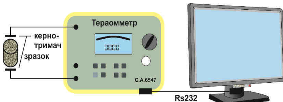
Рис.1. Схема вимірювання електричного опору сухих зразків керну
