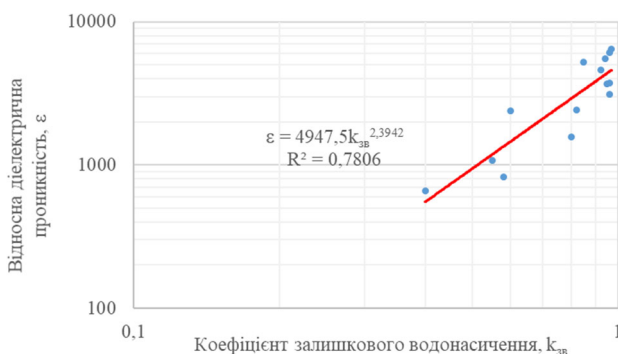
Рис. 8. Кореляційна залежність між коефіцієнтом залишкового водонасичення ( k_{зв} ) і відносною діелектричною проникністю ( \epsilon ) вапняків, насичених розчином NaCl
