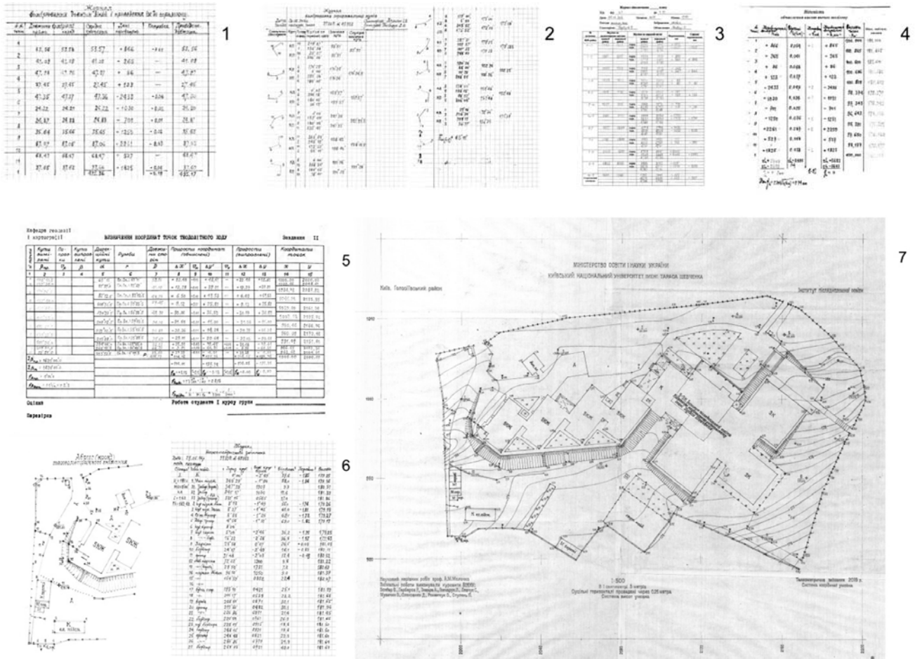
Рис. 2. Матеріали геодезичних вимірювань та обробки даних для побудови планово-висотної основи і виконання тахеометричного знімання в масштабі 1:500
