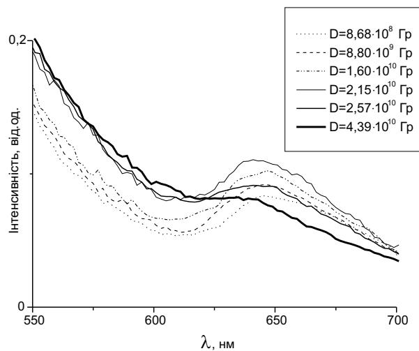
Рис. 3. Спектри іонолюмінесценції кварцу для різних доз ( $\beta = 30^\circ$ )
