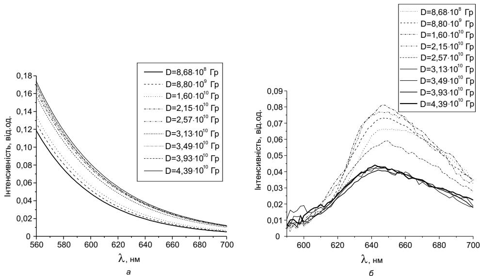
Рис. 4. Спектри іонолюмінесценції кварцу для різних доз ( $\beta = 30^\circ$ ) після математичної обробки: *a* — довгохвильова область першої смуги; *б* — друга смуга
