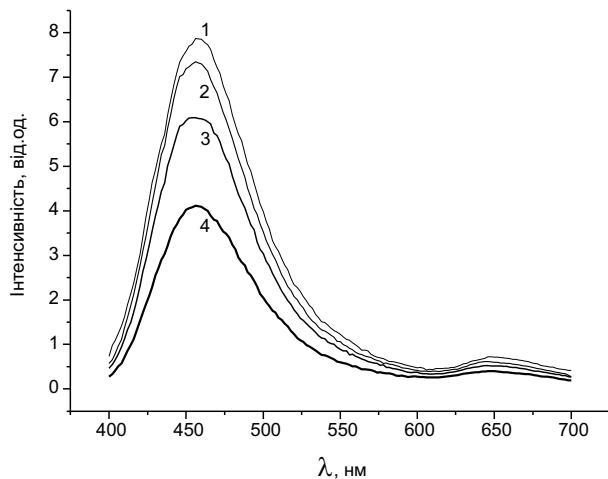
Рис. 2. Спектри іонолюмінесценції кварцу на початку опромінення для різних кутів спостереження  $\beta$ : 1 —  $0^\circ$ ; 2 —  $30^\circ$ , 3 —  $45^\circ$ , 4 —  $60^\circ$
