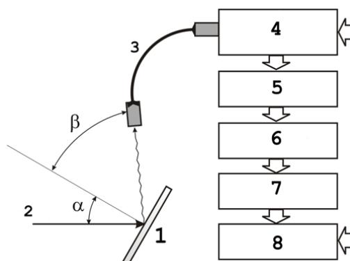
Рис. 1. Схема експерименту: 1 — мішень; 2 — пучок іонів; 3 — світловод; 4 — монохроматор; 5 — фотоелектронний помножувач; 6 — підсилювач; 7 — АЦП; 8 — комп’ютер
