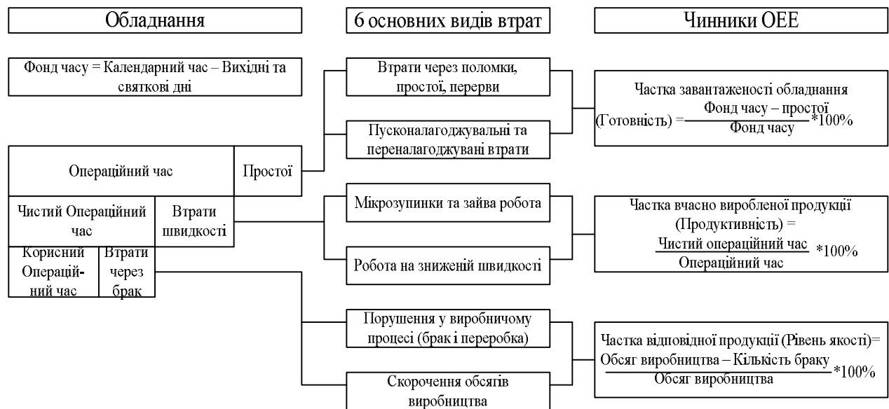
Рис. 2. Схема формування загальної ефективності роботи обладнання Джерело: [13].
