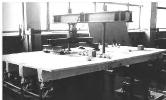
Фото 2. Загальний вигляд випробування прогонової будови без діафрагм
