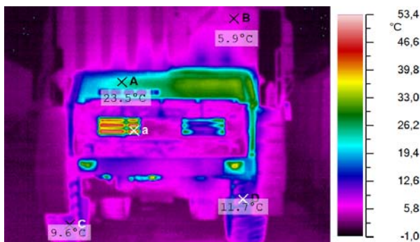
Рис.2. Температурне поле перед машини після першої їздки з вантажем
