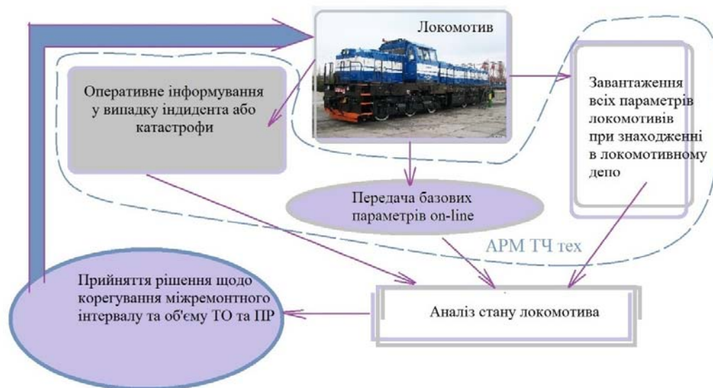
Рис. 2. Автоматизована система обліку та корегування ТОР локомотивів для УЗ
