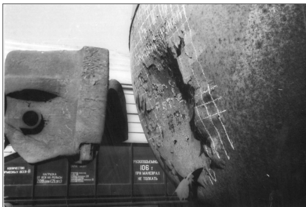
Рис. 9. Дослідний зразок після удару в котел автозчепом
