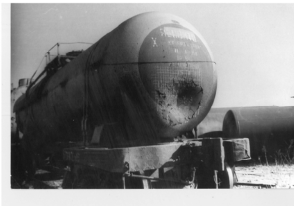
Рис. 3. Пошкодження котла цистерни
