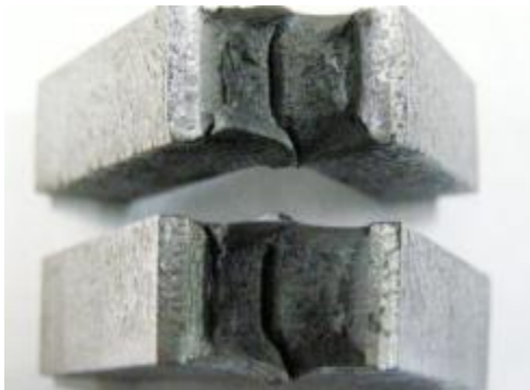
Рисунок 8 – Знімки зруйнованих зразків після випробування на ударну в'язкість: а – загальний вигляд зразків у вихідному стані; б – після рекомендованої термообробки; в, г – зони злому
