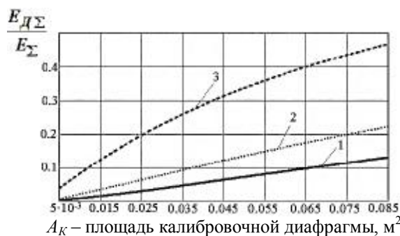
Рис. 3. Графики зависимости величины дополнительной освещенности от размеров калибровочной диафрагмы: 1 – для \rho = 0,9 ; 2 – для \rho = 0,95 ; 3 – для \rho = 0,99
