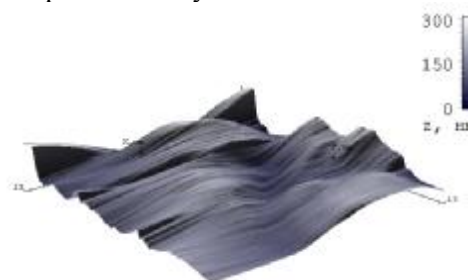
Рис. 6. Тривимірне АСМ-зображення фарбованого волосся без хімічної завивки
