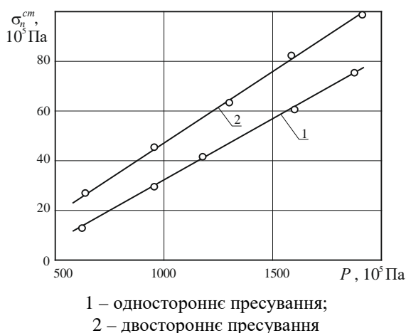
Рисунок 3 – Залежність межі міцності на стиснення суміші на основі МПФ – 2 (65 %) та \text{NaNO}_3 (30 %) від виду пресування (зразки діаметром 9 \cdot 10^{-3} м)
