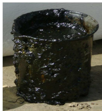
Рисунок 8 – Осад до фільтрації
