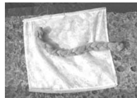
Рис. 1. Загальний вигляд завантажень: 1 — екран з флізелінової тканини; 2 — коса з синтетичного матеріалу
