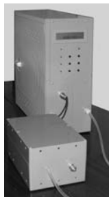
Рис. 4. Электрохимический реактор с внешним модулем перистальтического насоса
