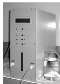
Рис. 2. Электрохимический реактор для синтеза высокочистых растворов гипохлорита натрия, оборудованный микроконтроллерной системой управления и контроля технологических параметров
