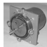
Рис. 3. Перистальтический насос с производительностью 7–10 л/ч
