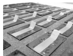
Рис. 1. Зразки для визначення міцності адгезійного з'єднання при відшаруванні
