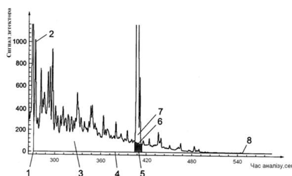
Типова хроматографа розрішення проби бензину з вмістом МЕЖК: 1 – введення проби (початок аналізу); 2 – 1-метилнафталін; 3 – площа, що відповідає висококиплячим складникам (включно з піком МЕЖК); 4 – базова лінія; 5 – площа під базовою лінією МЕЖК стосується висококиплячих складників і не є МЕЖК; 6 – базова лінія для обчислення МЕЖК; 7 – пік для обчислення вмісту МЕЖК; 8 – кінець аналізу (пік дотріаконтану – кінець фракції висококиплячих складників)
