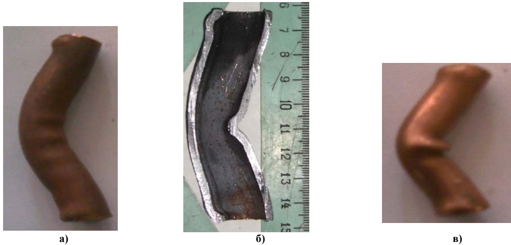
Рис. 3. Изогнутые патрубки с гофрами на внутренней части изгиба
