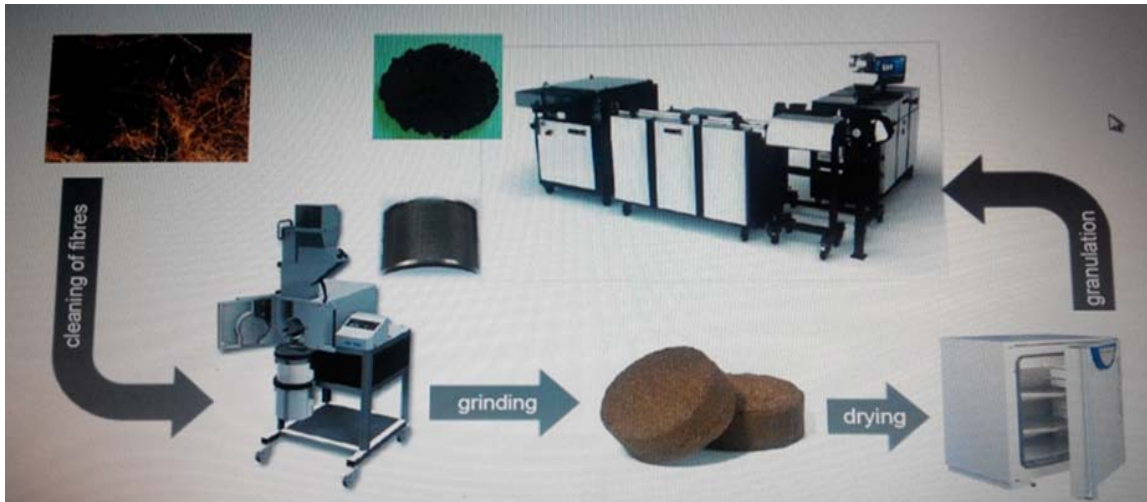
Рис. 1. Технологічний процес виготовлення композитів на основі натуральних волокон [7]
