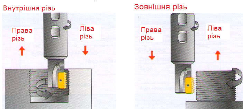
Рис. 1 Схема оброблення внутрішньої й зовнішньої різі на верстаті з ЧПК із використанням програми гвинтової інтерполяції [1]
