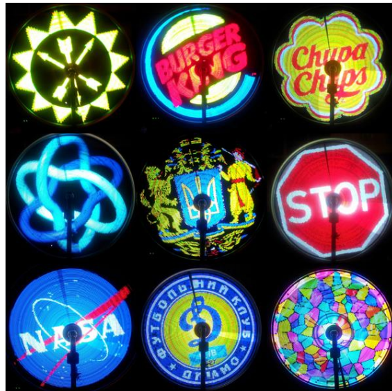
Рис. 11. Приклад виведення зображень із застосуванням повноколірного модуля, що містить 64 RGB діода
