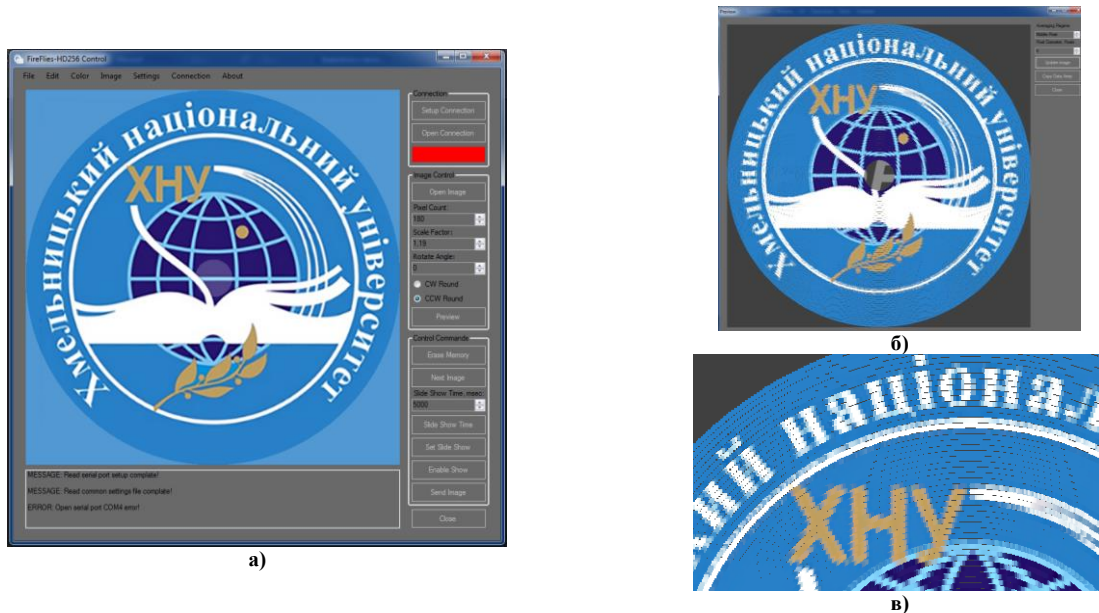
Рис. 9. Програмне забезпечення генерування коду для плати керування та формування зображення: а – модуль підготовки зображення; б – попередній перегляд зображення плоскої системи обертання; в – збільшений фрагмент генерованого варіанту зображення в модулі попереднього перегляду
