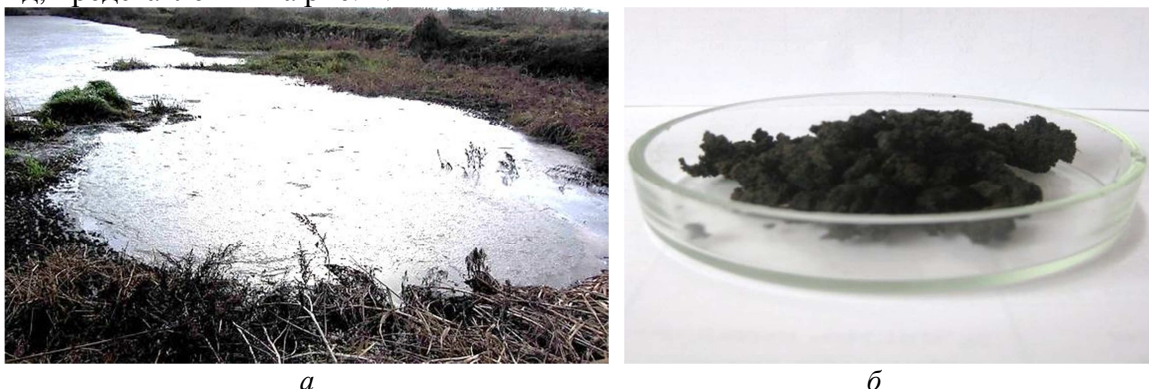
Рис. 4. Осад після біологічного очищення стічних вод: новоутворений осад на муловому майданчику (а) та осад, витриманий 12 місяців на муловому майданчику (б)
