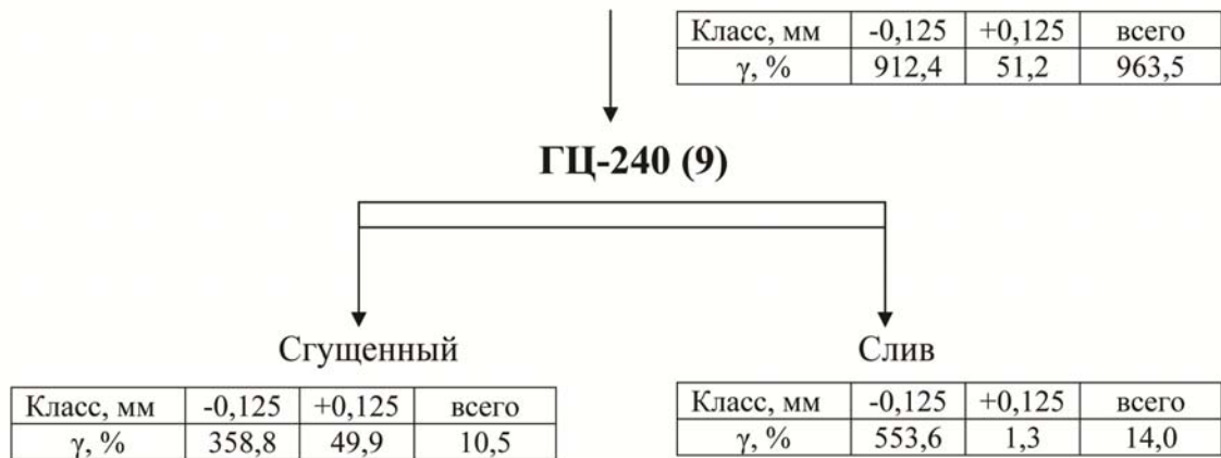
Рис. 2. Схема для расчета коэффициентов распределения тонкого и зернистого шлама
