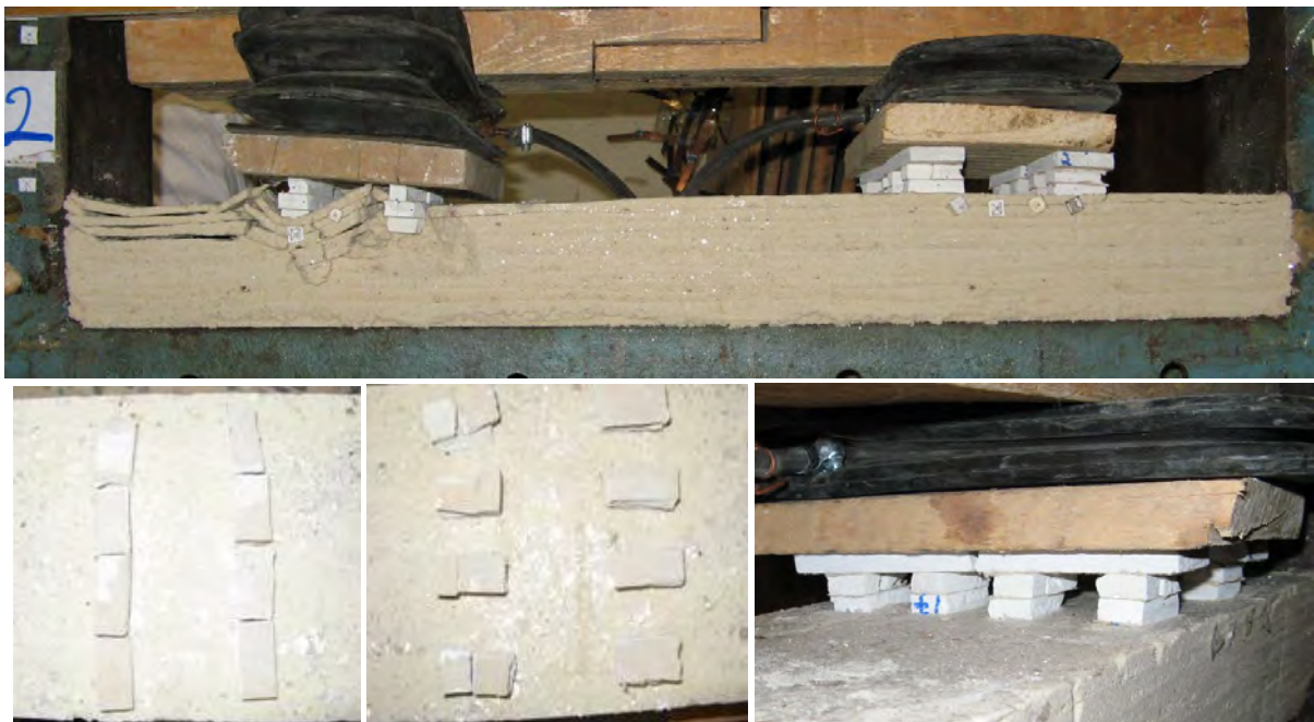
Рис. 5. Фотографії моделі з опорами для встановлення ефективності використання відокремлених опор
