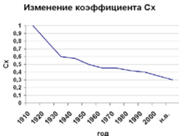
Рис. 3. Зависимость среднего значения C_x от года выпуска автомобиля (рассматривались только серийные модели) [10]
