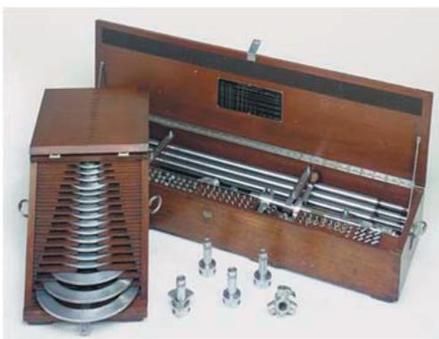
Рис. 2. Механический прибор контроля износа каналов стволов (США)
