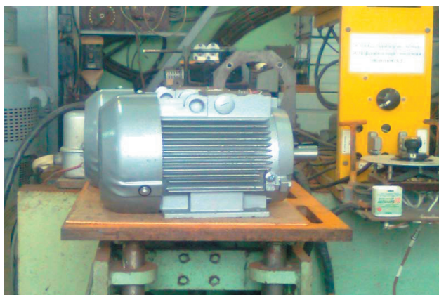
Рис. 2. Асинхронный двигатель типа АИР80В4 на испытательной станции
