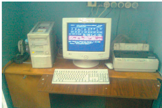
Рис. 3. Автоматизированная система регистрации измерений параметров испытываемых асинхронных двигателей
