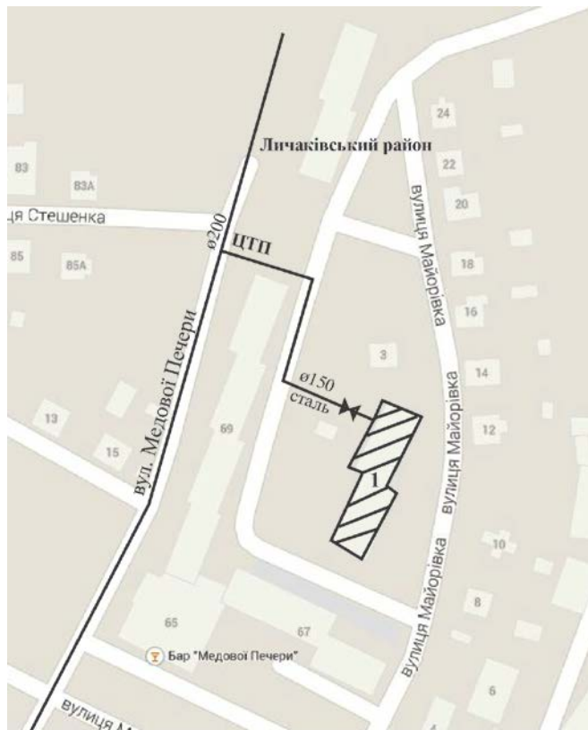
Рис. 4. Схема розташування досліджуваної ділянки водопровідної мережі вул. Майорівка, 1 (Личаківський район): насосна станція “Кривчиці” ø500 – вул. Козацька ø600 – вул. Тракт Глинянський ø600 – вул. Голинського ø600 – вул. Голубця ø600 – вул. Грибова ø600 – вул. Пасічна ø500 – вул. Медової Печери ø400 – вул. Медової Печери, 69А (ЦТП) ø200–вул. Майорівка, 1 (ввід у будинок – сталева труба ø150)
