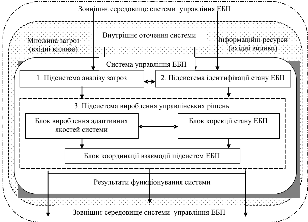
Рисунок 2 - Структура системи управління ЕБП
