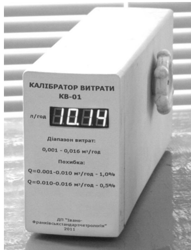
Рис. 4. Калібратор для повірки витратомірів газу в діапазоні від 0,001 до 0,016 м³/год
