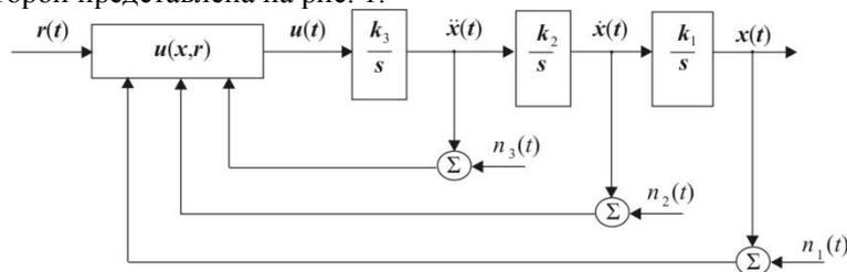
Рис. 1. Структура системи з трійним інтегратором і шумами в каналах вимірювання
