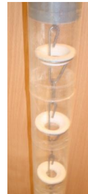
Рис 4. Скребкові шайби: а - із суцільною торцевою поверхнею; б - з внутрішніми отворами
