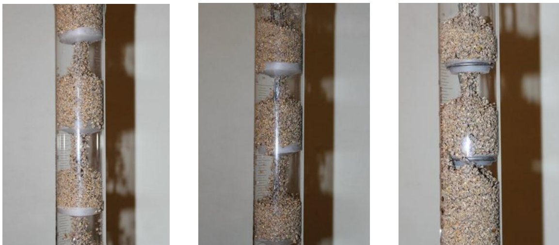
Рис.7. Процес транспортування мікрогранульованого комбікорму з різним коефіцієнтом завантаження шайбових скребків
