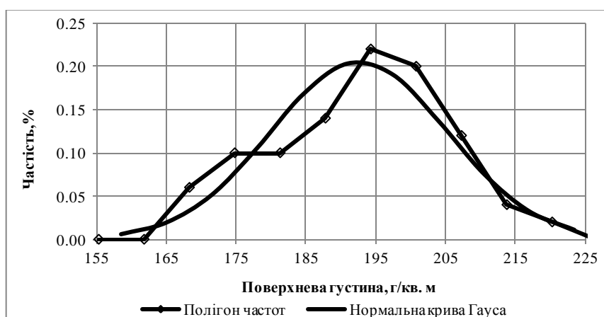
Рис. 4. Полігон частот і нормальна крива розподілу поверхневої густини термоскріпленого геотекстилю Турар SF-56
