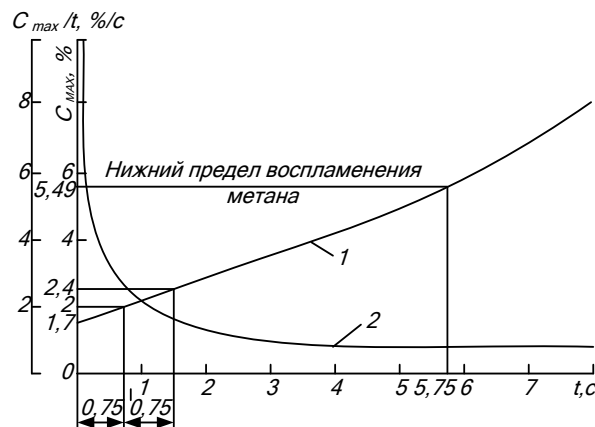
Рисунок – 3 График изменения концентрации метана в выработке после внезапного выброса на расстоянии 7 м от забоя: 1 – зависимость изменения концентрации метана от времени после выброса; 2 – скорость нарастания концентрации метана
