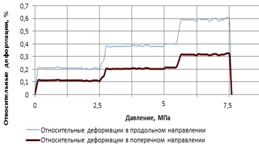
Рисунок 5 – График относительных деформаций элемента нефтепровода в продольном и поперечном направлениях при нагружении давлением
