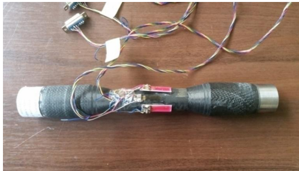
Рисунок 3 – Элемент нефтепровода с тензодатчиками
