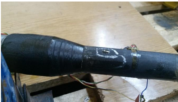
Элемент нефтепровода из исходного углеродного волокна УКН/5000
