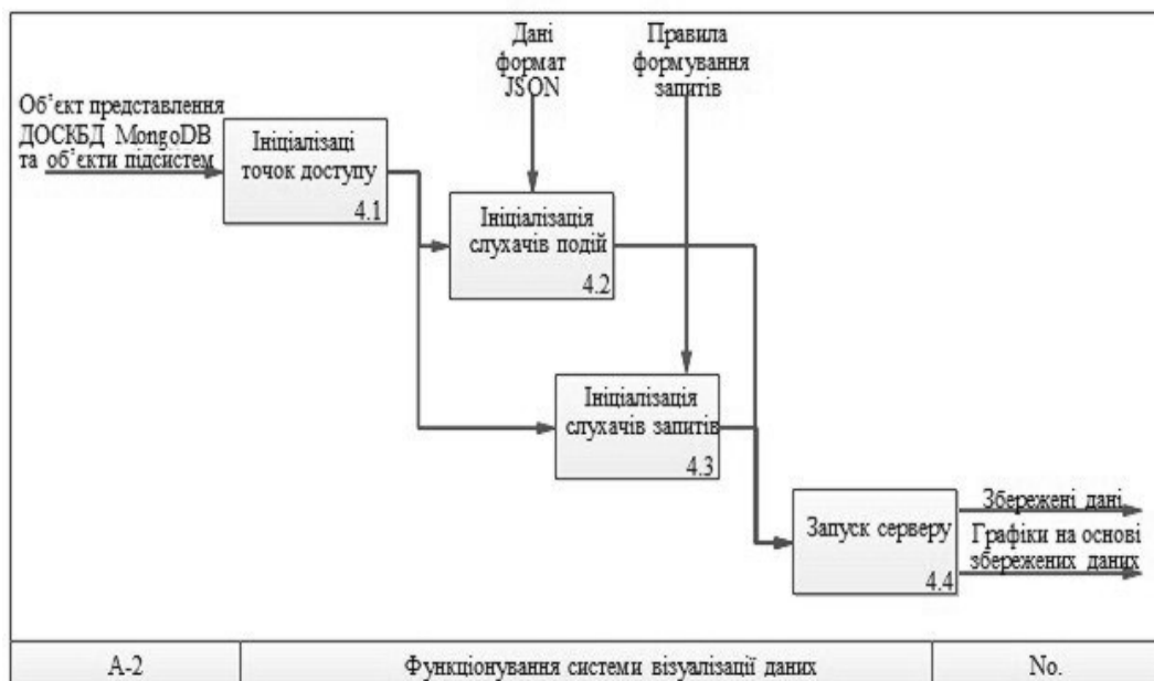
Рис. 3. Декомпозиція процесу запуску серверу обробки даних
