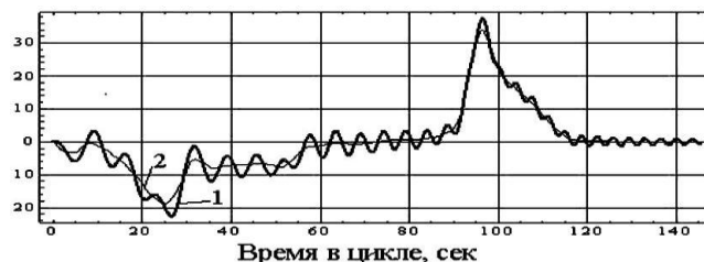
Рис. 2. Напряжение в точке касания каната со шкивом намотки
