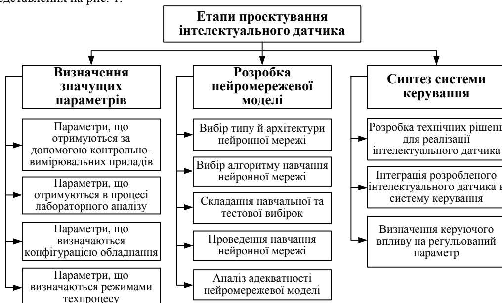
Рис. 1. Етапи побудови й інтеграції віртуального датчика на основі НМТ в АСУ ТП
