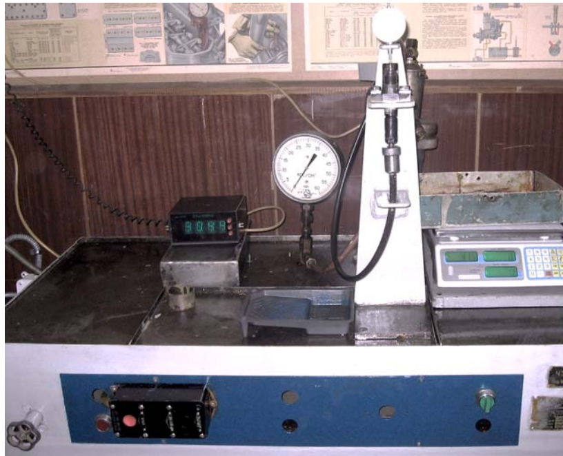
Рис. 1. Установа для проливання розпилювачі під постійним тиском
