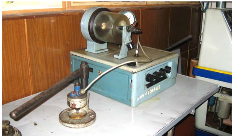
Рис. 2. Загальний вигляд установки для визначення діаметра запирання
