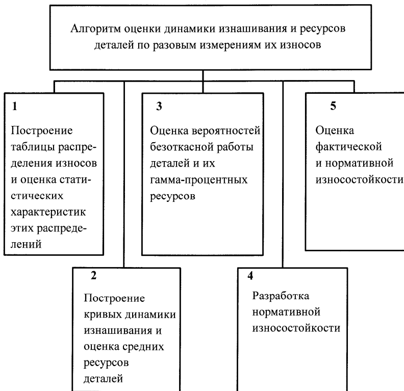
Рис.3. Последовательность оценки динамики изнашивания, ресурсов деталей, нормирования и оценки соответствия фактической и нормативной износостойкости.
