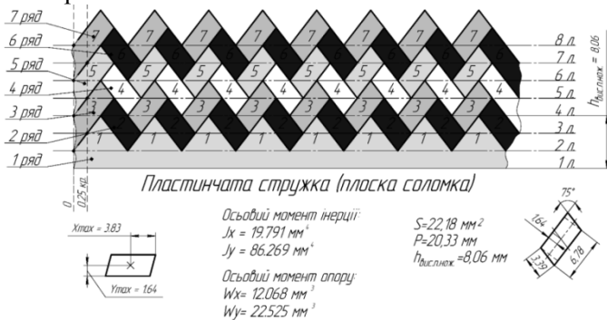
Рис. 2. Схема зрізання та основні геометричні характеристики пластинчатої стружки
