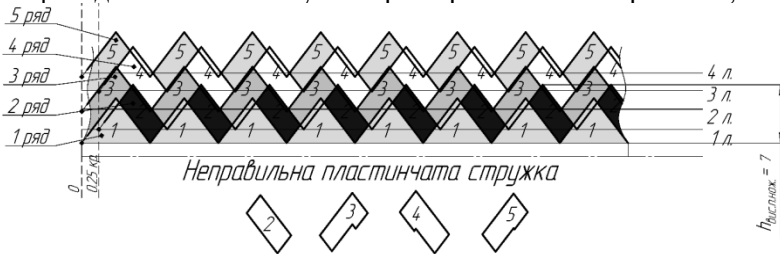
Рис. 4. Схема зрізання неправильної пластинчастої стружки (плоскої соломки)
