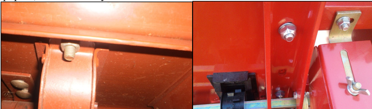
Рисунок 3 – Вихід стрижня болта за межі гайки: а) сівалка 2008 р.в.; б) сівалка 2014 р.в.
